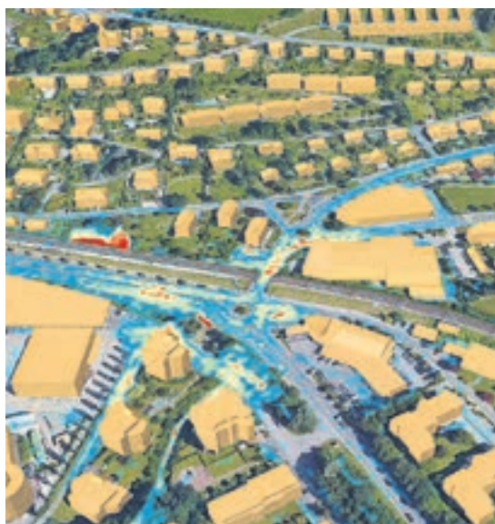
Mit Computersimulationen soll die Überschwemmungsdynamik analysiert und in der Folge das Würzenbachquartier besser vor Hochwasser geschützt werden.
