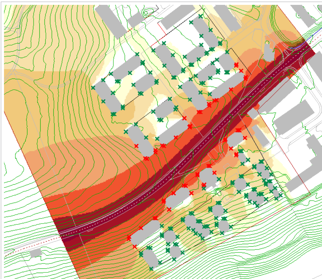
Abb. 10: Berechnung städtebauliche Studie (Stand 2014), Darstellung mit Immissionspunkten; rote Kreuze: überschrittener PW (Tag oder Nacht)
