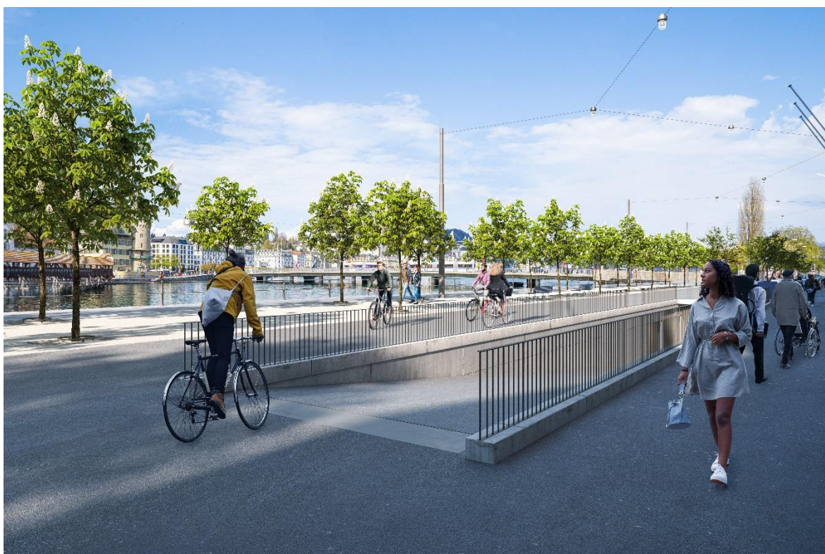
Abb. 12: Die befahrbare und im Winter mit See-Energie geheizte Rampe zur Velostation
