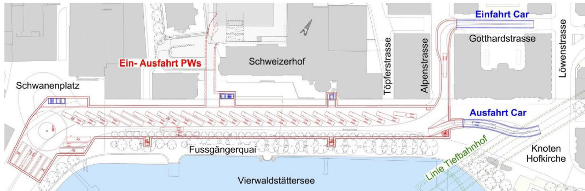
Schmales Seeparking: Grundriss 1. Untergeschoss mit 37 Carslots
