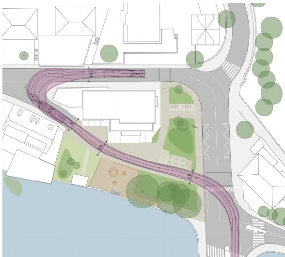
Abb. 46 Wenderadien und Schleppkurven Gestaltung, Multifunktionspark, Variante A
