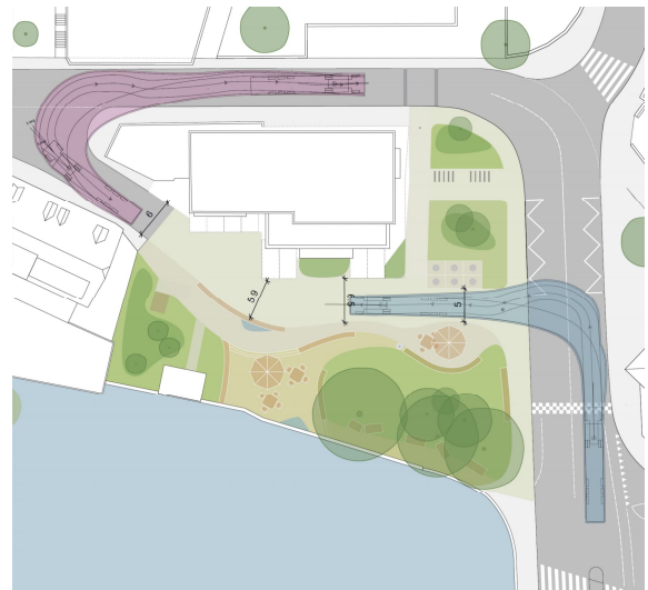
Abb. 47 Wenderadien und Schleppkurven Gestaltung, Multifunktionspark, Variante B
