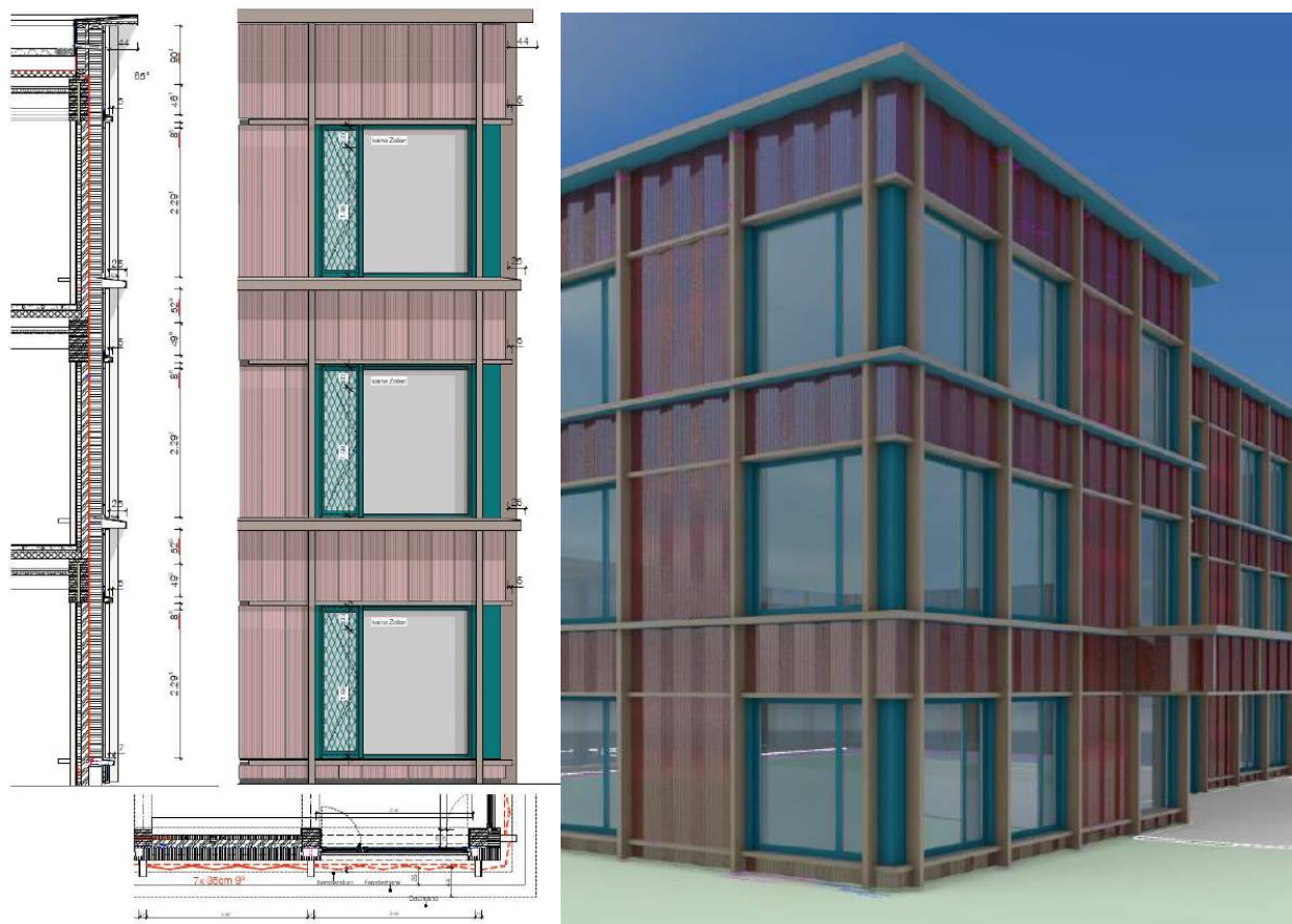
Abb. 14: PV-Anlage Fassade: Fassadenschnitt, Ansicht, Grundriss, Visualisierung
