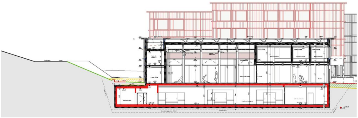
Neubau Dreifachturnhalle mit Aula: Schnitt A8
