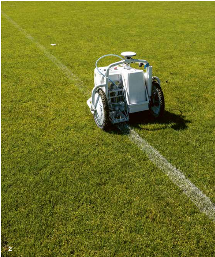
1 Für eine perfekte Infrastruktur: Das Team vom Ressort Aussensport unterhält die ganzen Aussensportanlagen in der Stadt Luzern, vom Rasen über den Kunstrasen bis zu den Zaunanlagen. 2 Moderner Linienzeichner: Der GPS-gesteuerte Roboter zeichnet die Linien auf den Fussballfeldern. 3 Um die Rasenhöhe kümmern sich unter anderem auch elektrische Mähroboter.
