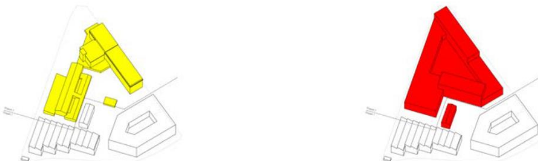
Abb. 6: Zweite Bauetappe mit Abbruch (gelb) nördlicher Teil und Neubau (rot), sowie Sanierung «Rotes Haus»
