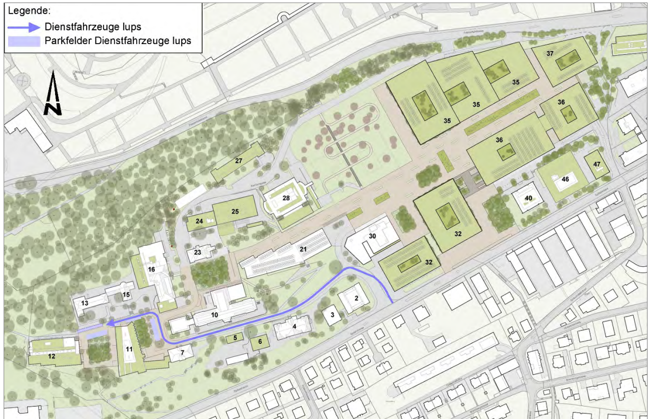
Abbildung 27: Erschliessungskonzept Dienstfahrzeuge lups
