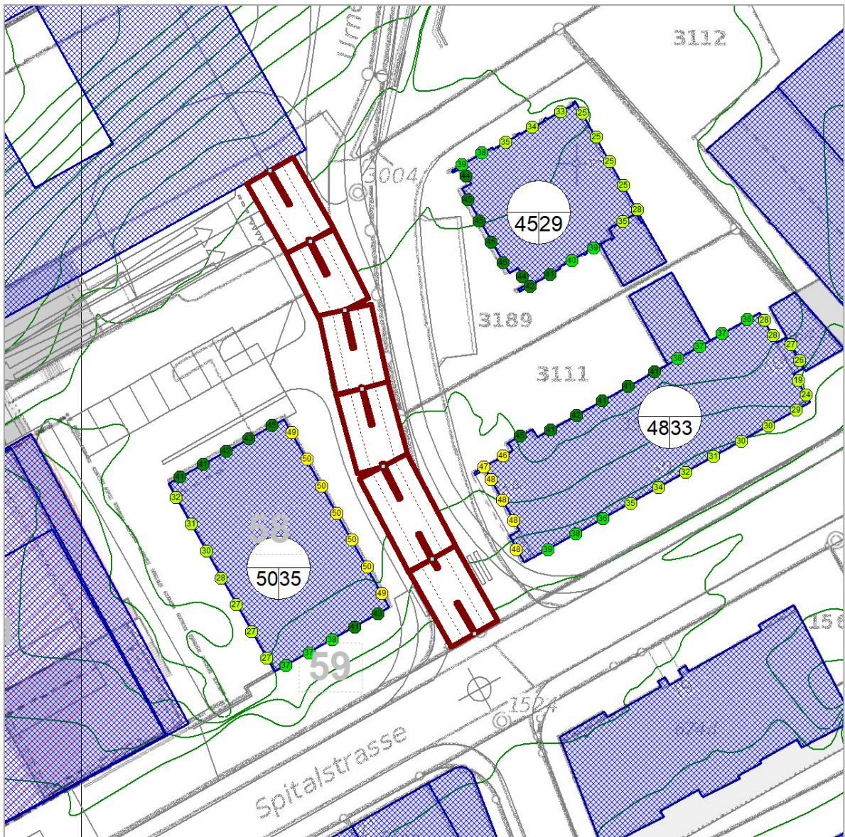
Abbildung 22: Berechnete Verkehrslärm-Immissionen entlang des Urnerhofwegs im Ausgangszustand (ohne Projekt BP) 2036
