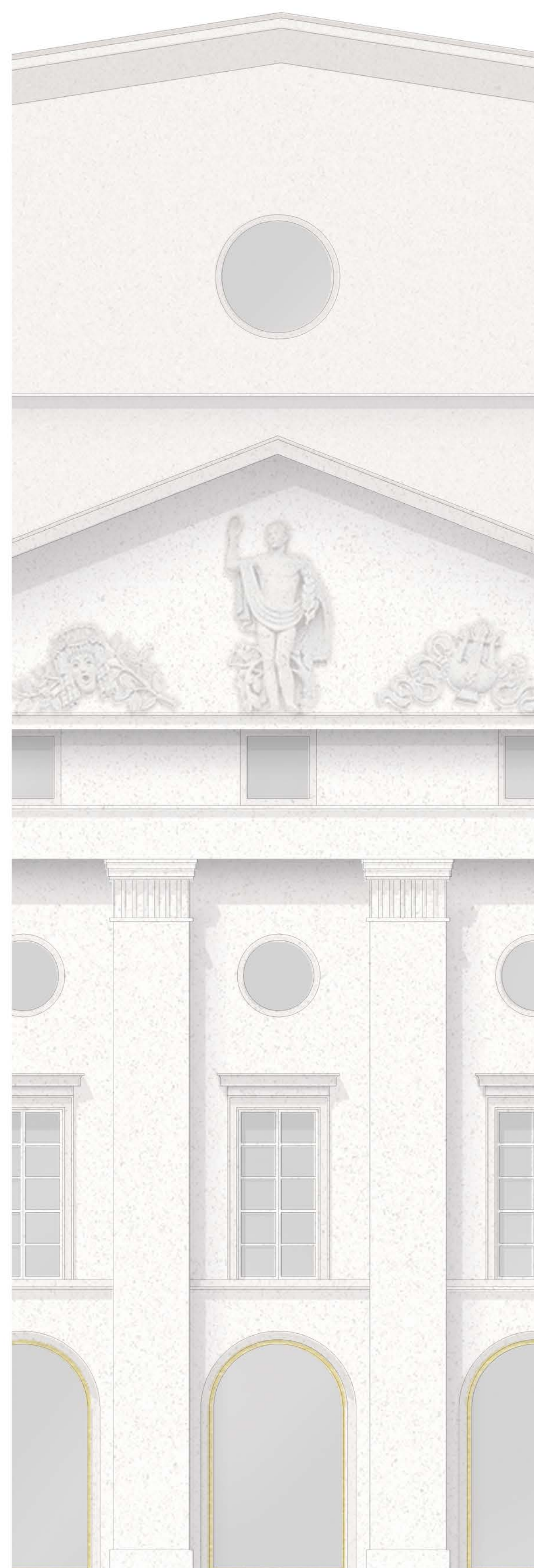
Fassadenansichten 1:50, Verputzt - Naturstein - Verglasung
