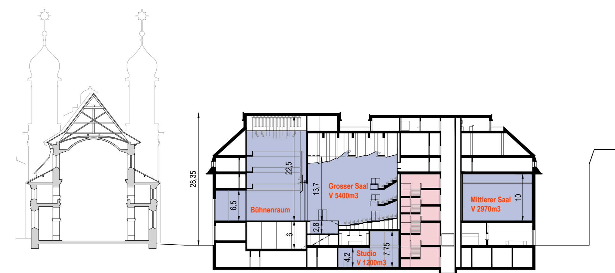
Raumverteilung und Hauptabmessung 1:500
