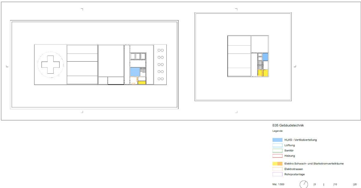
Abbildung 23: Dachaufsicht des neuen Kinderspitals und der Frauenklinik mit den Standorten der HLK-Anlagen, Luzerner Kantonsspital
