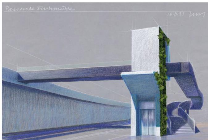
Abb. 2 und 3: Visualisierungen der Passerelle Variante mit Liftturm, Treppe und Trogbrücke
