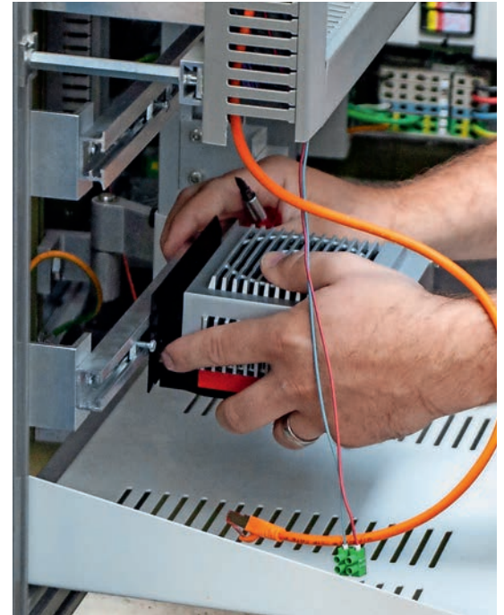
6 | Einbau des Industrie-PCs in den Steuergeräteschrank.
