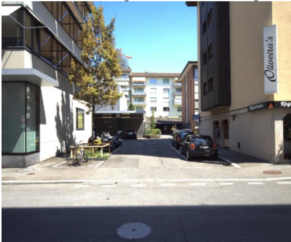
Abbildung 4: Mangelhafte Sichtweite aus der Hofstrasse in die Weystrasse
