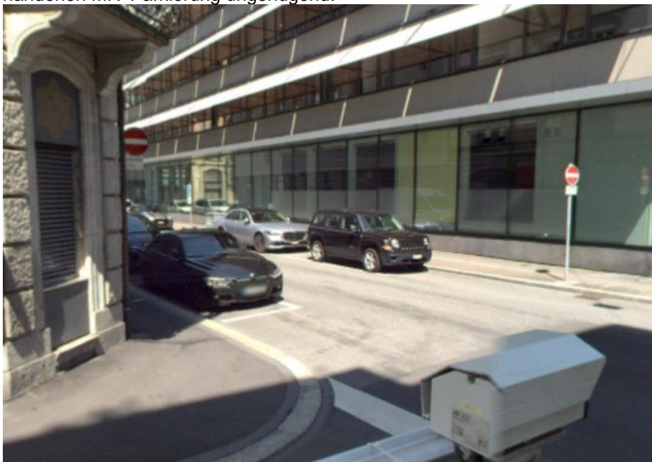
Abbildung 4: Mangelhafte Sichtweite aus der Hofstrasse in die Weystrasse
